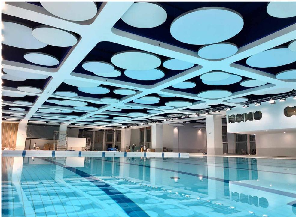
Conformément aux demandes de la direction technique, l'ensemble des cadres sont amovibles et inclinables permettant ainsi d'accéder au réseau à tout moment. La solution CLIPSO répondait également aux attentes environnementales du cabinet d'architecture en proposant un produit labélisé écoenvironnemental (A+ et GREENGUARD Gold et sans PVC).
